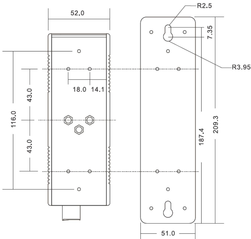
Рис.2 Размер настенного крепления
