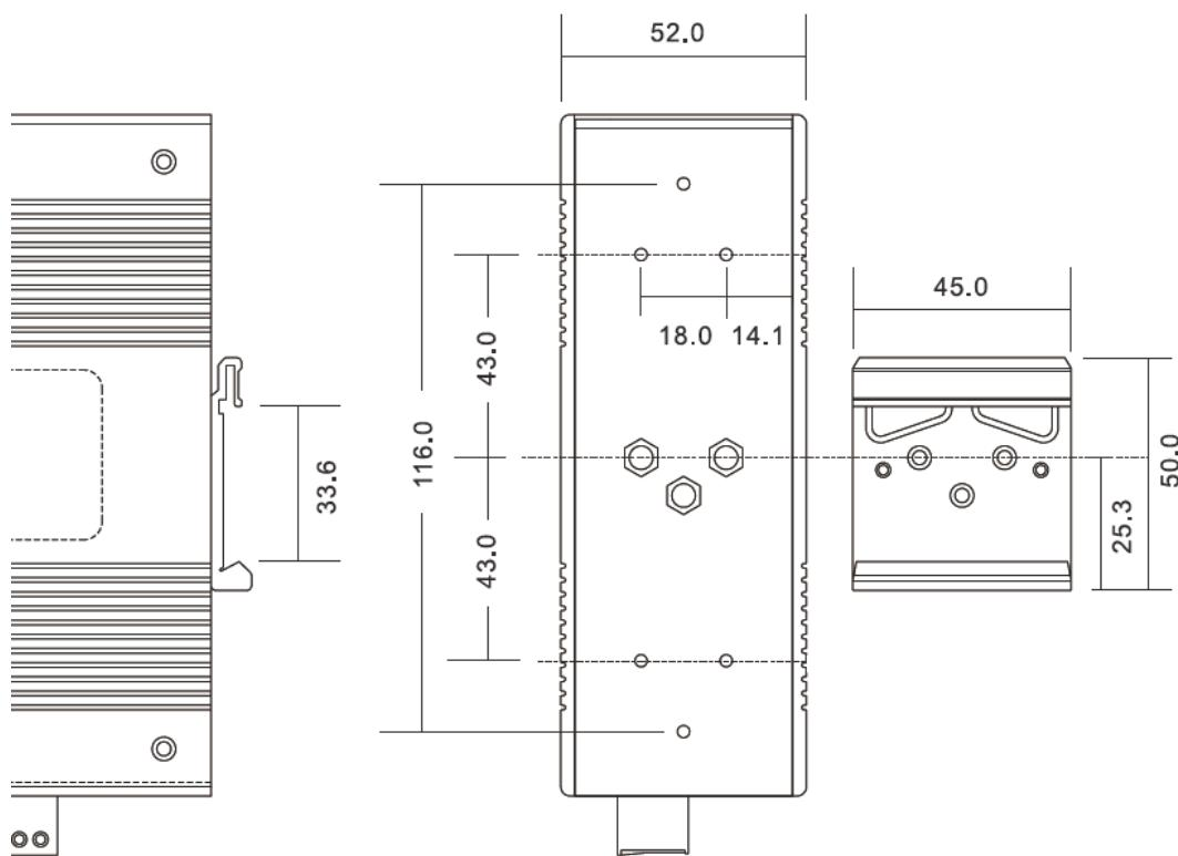
Рис.1 Размер крепления на DIN-рейку
